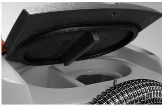
L'accès facile au réservoir de récupération permet un nettoyage rapide et efficace ; le réservoir basculant ainsi que le flexible d'évacuation permettent la vidange complète du réservoir même en présence de résidus solides. Le dispositif anti-mousse protège le moteur d'aspiration, ainsi que l'interrupteur électronique à flotteur qui interrompt l'aspiration lorsque le réservoir d'eau sale est plein.
